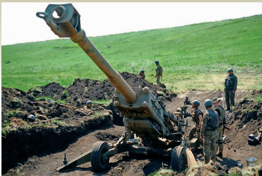
Lahke vlečne havbice M 777 kalibra 155 mm so eno od orožij, ki jih bo Ukrajina še zelo potrebovala med vse bolj simetričnim spopadom v Donbasu. (Foto: Збройні Сили України – OS Ukrajine)
