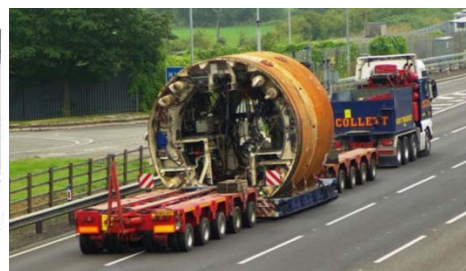
Slika 35 – Primer možnega prevoza TBM s tovornjakom
